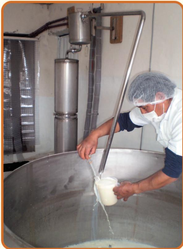
Leche pasteurizada a  $72^{\circ}\text{C}$  por 30 segundos es obtenida por un pasteurizador que transfiere calor a la leche a partir de agua calentada con energía solar, se llega a obtener una temperatura máxima para la pasteurización de la leche.
