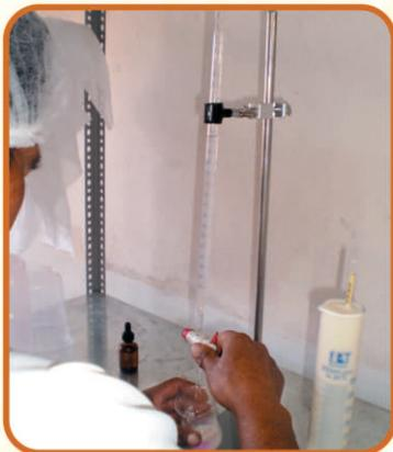
4. Se titula adicionando gota a gota la solución de hidróxido de sodio 0.1 N. al mismo tiempo se agita el vaso de precipitado lentamente.
